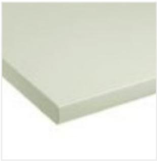
Costituiti da un supporto in conglomerato ligneo, resistenza alla flessione secondo DIN 52362 ed al rigonfiamento secondo DIN 52364, spessore minimo mm.25, viene applicato un rivestimento in laminato melamminico secondo DIN 16926, resistente alla luce secondo DIN 53388, resistenza all'abrasione ed agli urti secondo DIN 53799.
