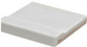
Il Corian è un materiale non poroso ed omogeneo, costituito da 1/3 di polimetilmetacrilato e 2/3 di sostanze naturali la cui principale è il triidrato di alluminio. E' indicato come piano di lavoro da laboratorio soprattutto nei settori dove è richiesta un'alta igienicità come quello medico, microbiologico o alimentare. Bordi perimetrali di contenimento per liquidi.
